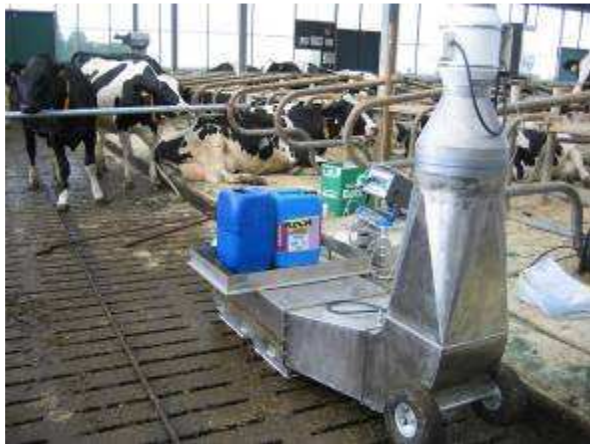
Figuur 3 De meetbox op de roostervloer
